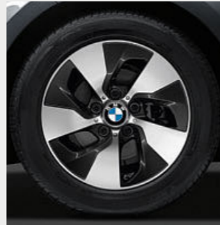
Jantes en alliage léger 16" (41 cm) style 406 Turbine BMW EfficientDynamics, en « Orbitgrau », polies, à l'aérodynamisme optimisé. Dimensions : 7J x 16, pneumatiques 205/55 R16.
